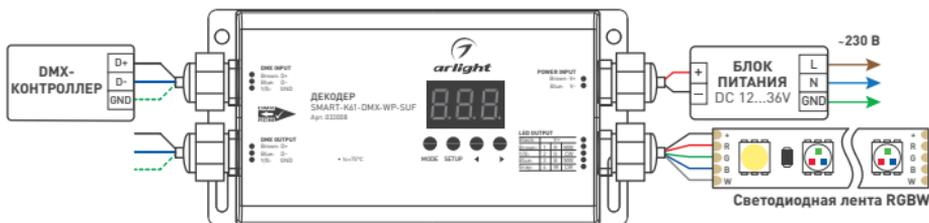
Рисунок 1. Подключение декодера SMART-K61-DMX-WP-SUF
